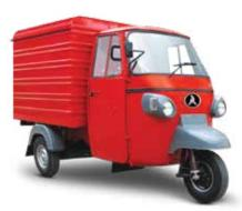
REAR ENGINE | DELIVERY VAN 500 KG PAYLOAD CAPACITY
