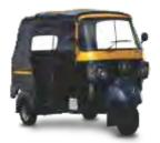
REAR ENGINE PASSENGER 3+1 DIESEL
